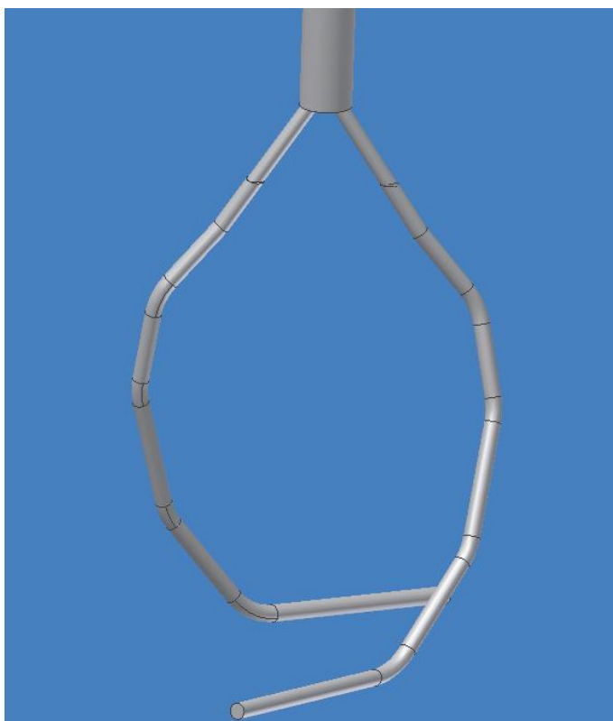
Figur 15 Alternativ 3, multilateral brønnbane tegnet i DAK programmet inventor
