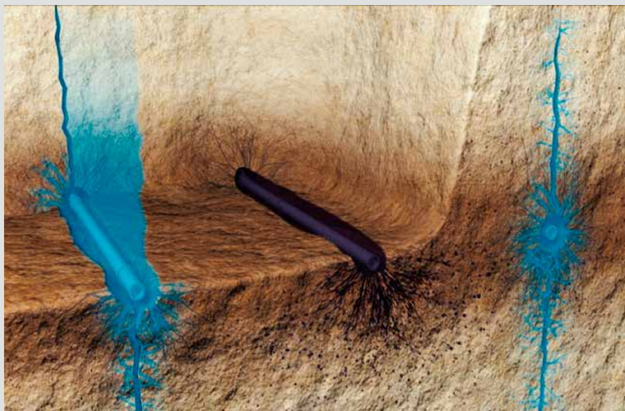
Illustrasjon av vann som injiseres i en brønn for å presse oljen ut
