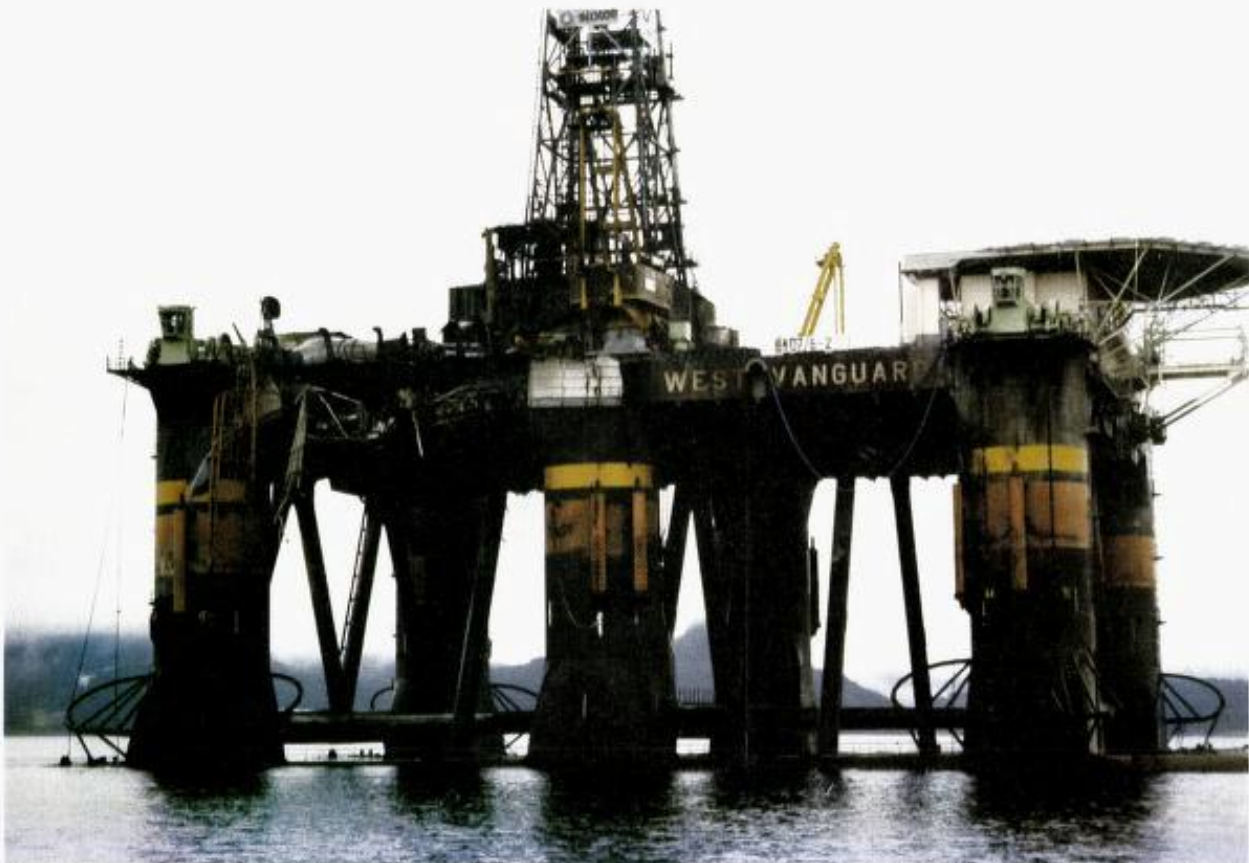
Fig. 4.1. Fotografi av boreriggen «West Vanguard» sett fra styrbord side. Skottet i Engine Room er sprengt åpent. Bildet er tatt den 5. november mens riggen lå i Freifjorden.
