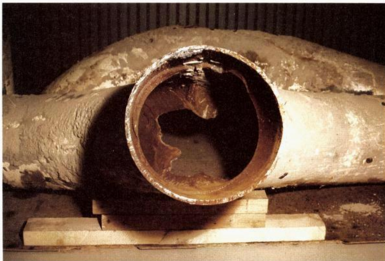
Fig. 4. Deler fra West Vanguard som viser erosjon.
