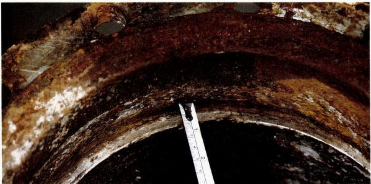
Foto 16. Ventilen åpnet ikke helt.
