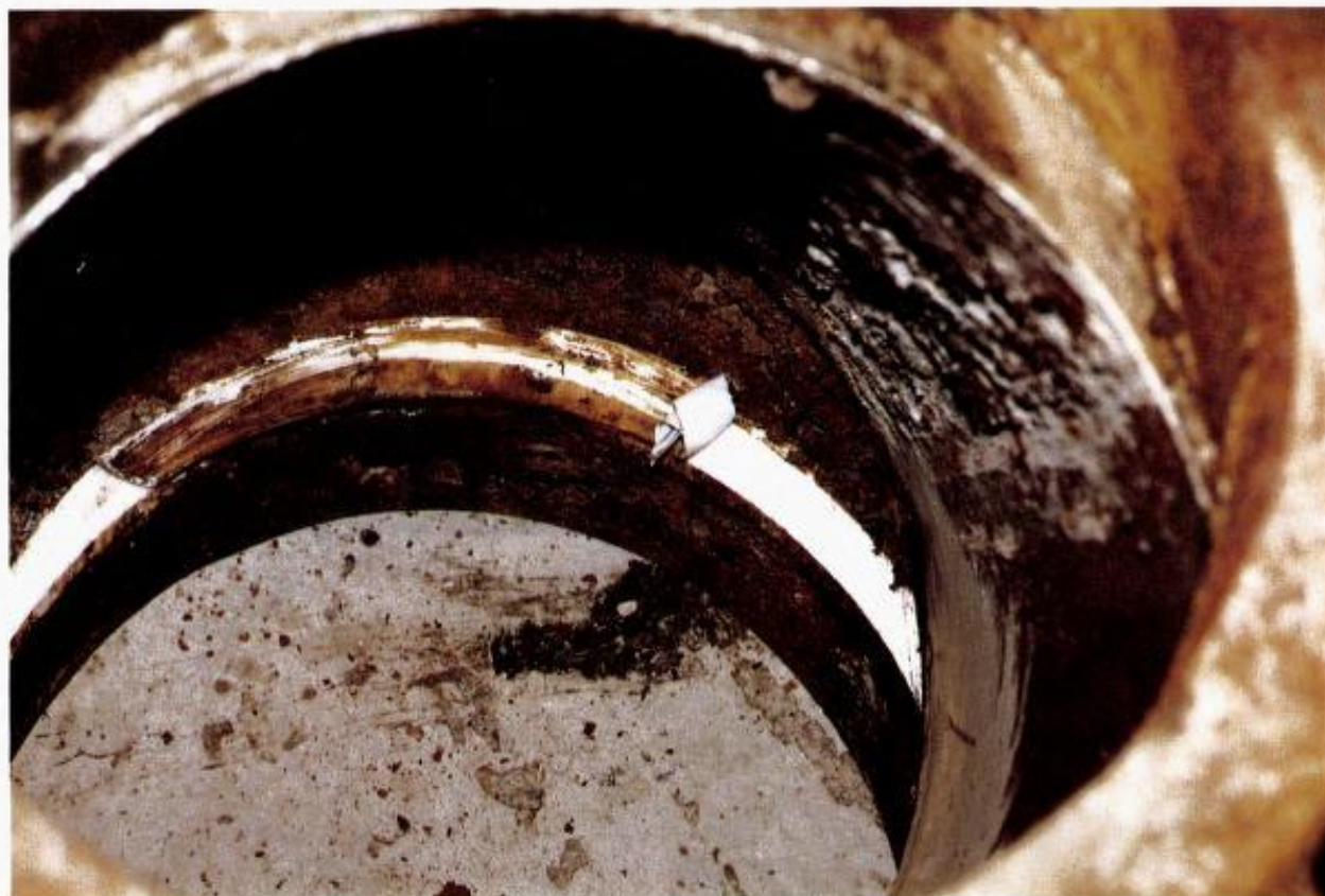
Foto 19. Av-skavning av teflontetning.
